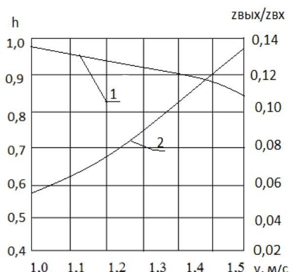
**Рис. 4. Зависимость степени очистки (1) и проскока тумана кислоты(2) от скорости газа в ЭФ**
