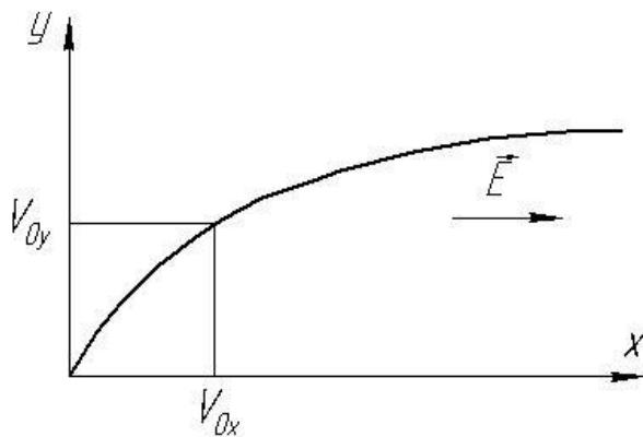
**Рис.12. Траектория движения заряженной частицы в электрическом поле напряженностью  $\vec{E}$ .**
