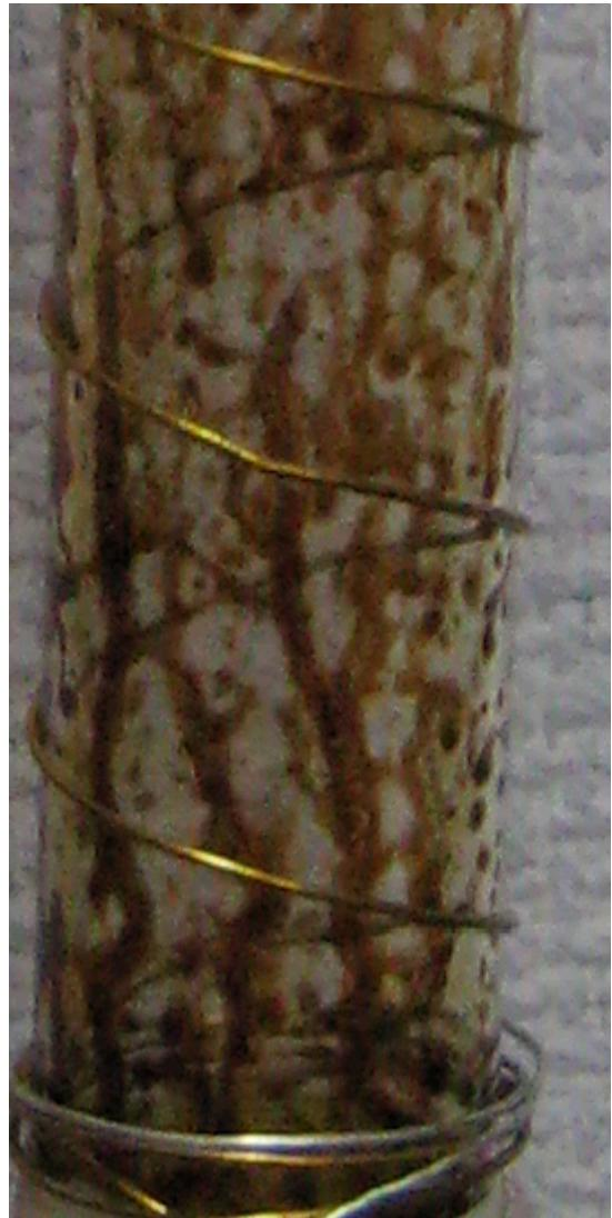
**Рис 10. Осаждение частиц сажи внутри стеклянного осадительного электрода**
