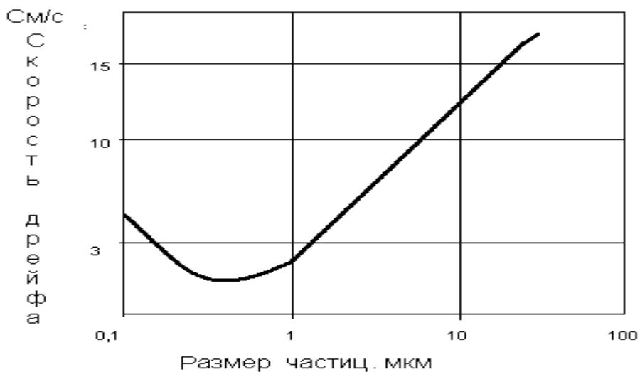
**Рис. 5 Качественная зависимость скорости дрейфа частиц от их дисперсного состава**
