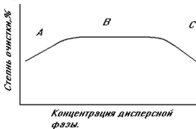
Рис.2 Характер зависимости степени очистки газов в ЭФ от концентрации дисперсной фазы.
