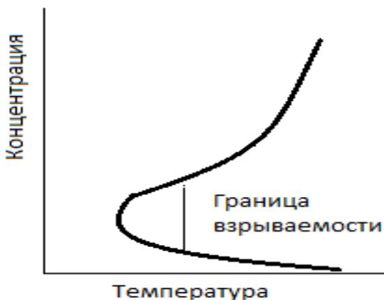
Рис. 8. Зависимость взрывной концентрации от температуры воспламенения.
