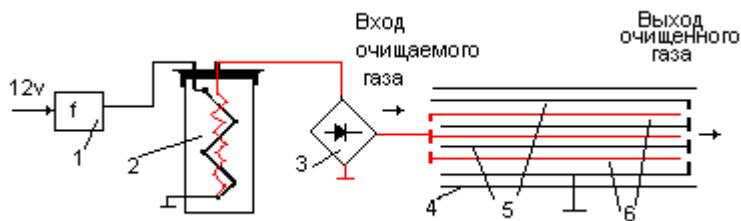
**Рис14. Схема очистки выхлопных газов автомобиля.**
