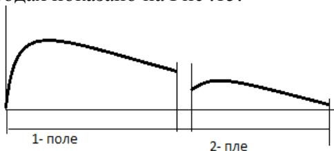
**Рис.15. Качественное распределение пыли, уловленной на осадительных электродах**
