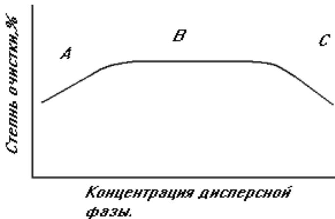
Рис.2 Характер зависимости степени очистки газов в ЭФ от концентрации дисперсной фазы.
