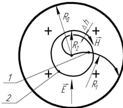
**Рис. 13. Траектории движения электронов и отрицательно заряженных ионов.**
