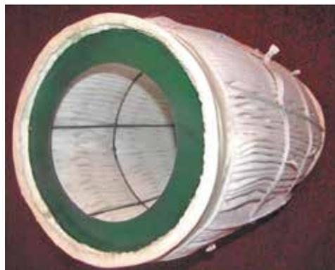
► Рис. 8. Плотная укладка фильтрэлемента
