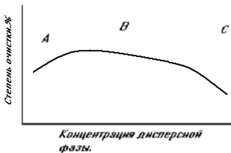
Рис. 2.14. Характер зависимости степени очистки газов от концентрации дисперсной фазы
