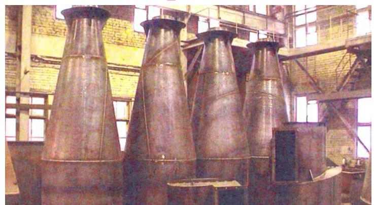
Изготовление циклонов осуществляется экспериментально-производственный цех холдинга, оснащенный всем необходимым оборудованием, позволяющим изготавливать широкий спектр инерционных пылеуловителей. Только за последнее время холдинг осуществил поставку следующих типов циклонов для предприятий России:
