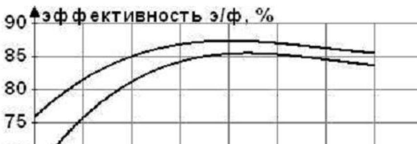
**Рис. 2. Зависимость эффективности улавливания от плотности тока**
